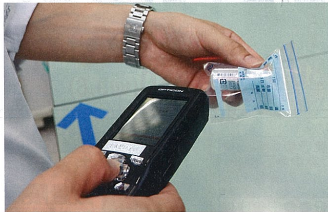
目薬を入れた袋の上からでも目薬本体に表示されているGS1-RSSコードをハンディターミナルで読み取れる。空いた時間に封入しておけるので効率性向上に貢献している
