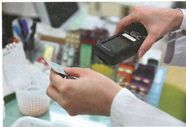
薬に付いたバーコードをハンディターミナルで読み取る。ミスがあればエラー表示とエラー音で注意喚起する。
