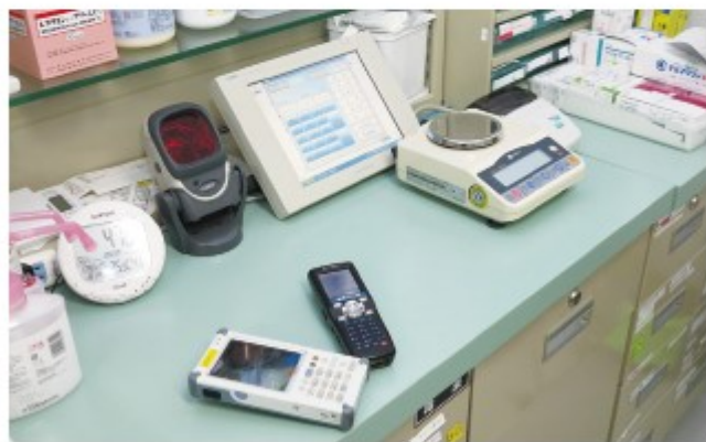
ミスゼロ子の散薬監査システム。秤量値までチェック。
