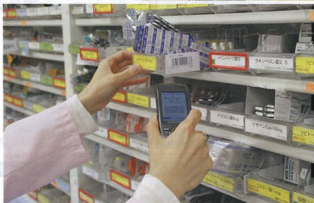
ミスゼロ子のハンディ端末で錠剤ケースに貼られたバーコードをスキャンする。正しい薬品を選んだ場合、薬品名・数量が表示され、誤った場合はエラー表示が出る。
