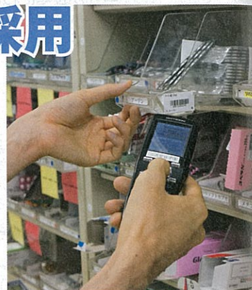
バーコードピッキングシステム「ミスゼロ子」によって、大きな調剤ミスを防ぐことができる
