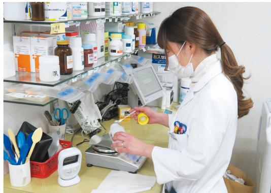
ニー薬局において、株式会社クカメディカルが提供する調剤ミス防止システム「ミスゼロ子」を導入した。専用のハンディ端末で医薬品のバーコードを読み取り、処方箋入力情報と照合することで、調剤ミスを未然に防ぐシステムである。
